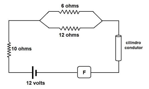
Nele, essa pessoa irá instalar um fusível (F), que interrompe a passagem de corrente pelo circuito, caso ela seja superior a 0,6 A. Para tal montagem, ele dispõe de dois cilindros condutores, de material e dimensão distintos, conforme as especificações a seguir:
