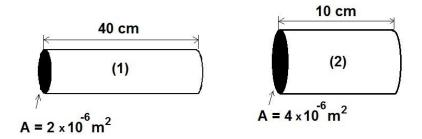
A resistividade elétrica do material (1) é 3 x  $10^{-5}$   $\Omega$ .m e a do material (2) é 8 x  $10^{-5}$   $\Omega$ .m e "A" representa a área da secção reta de cada cilindro condutor.
